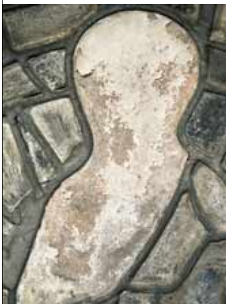
L'eau décompose le verre. La corrosion sur la face extérieure de l'objet obscurcit la représentation de L'Été. Détail d'un des médaillons de la rosace de la cathédrale de Lausanne, début du XIII e siècle
